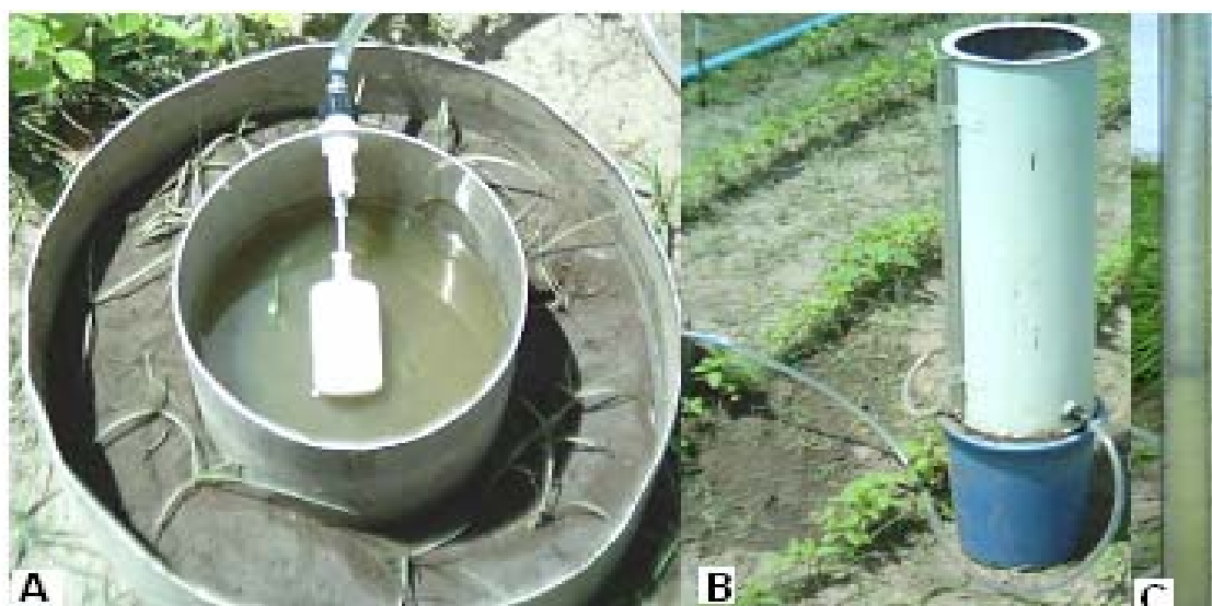
Figura 4. Cilindro infiltrômetro com bóia reguladora do nível da água (A), reservatório de alimentação para manter o nível constante no cilindro interno, conservando-se uma coluna média de 15 cm de altura em relação à superfície do solo (B), régua graduada para medida do nível da água dentro do reservatório (C)
