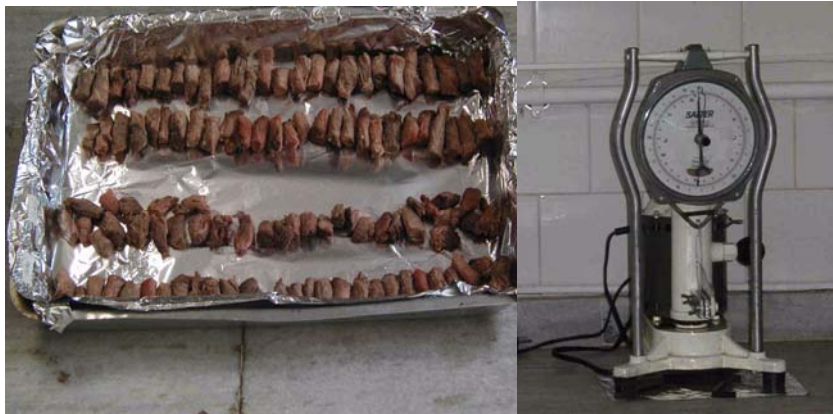
FIGURA 11 - Amostras cozidas até a temperatura interna de 71°C, cortadas em cilindros de 1,27cm pelo texturômetro “Warner-Bratzler Meat Shear Force – Modelo 3000”.
