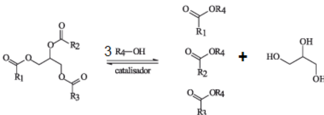
Figura 2 – Esquema da reação geral de transesterificação do triacilglicerídeo.
