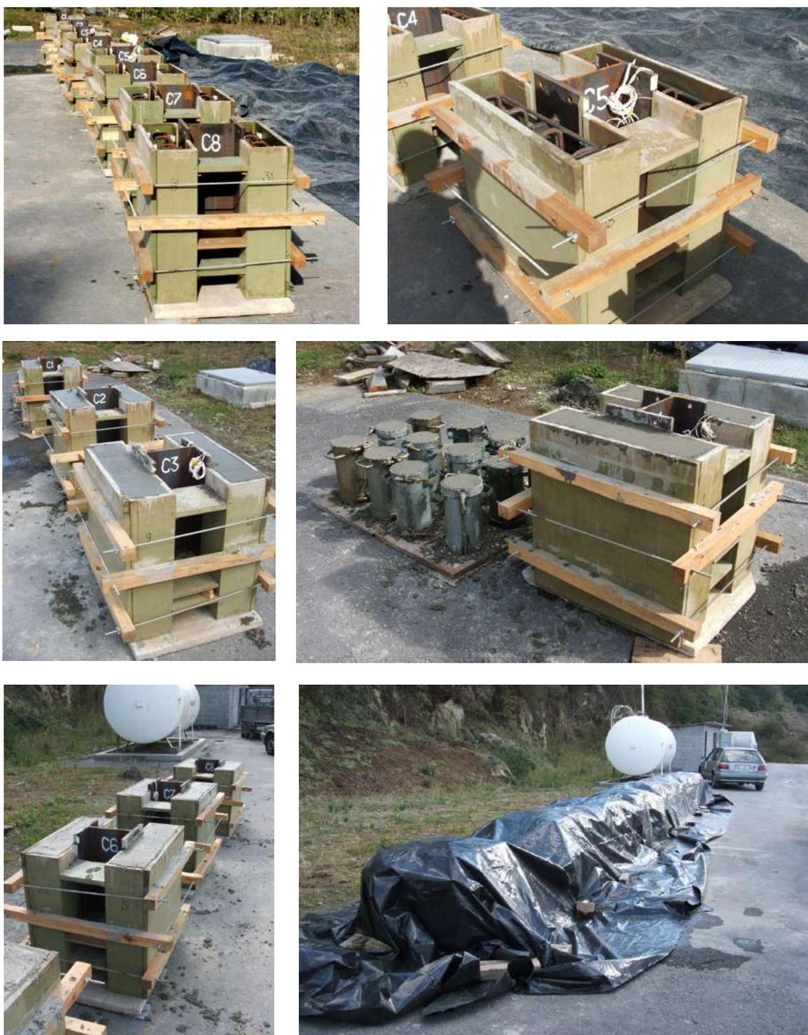
FIGURA 3.68 – Concretagem dos modelos da série C.
