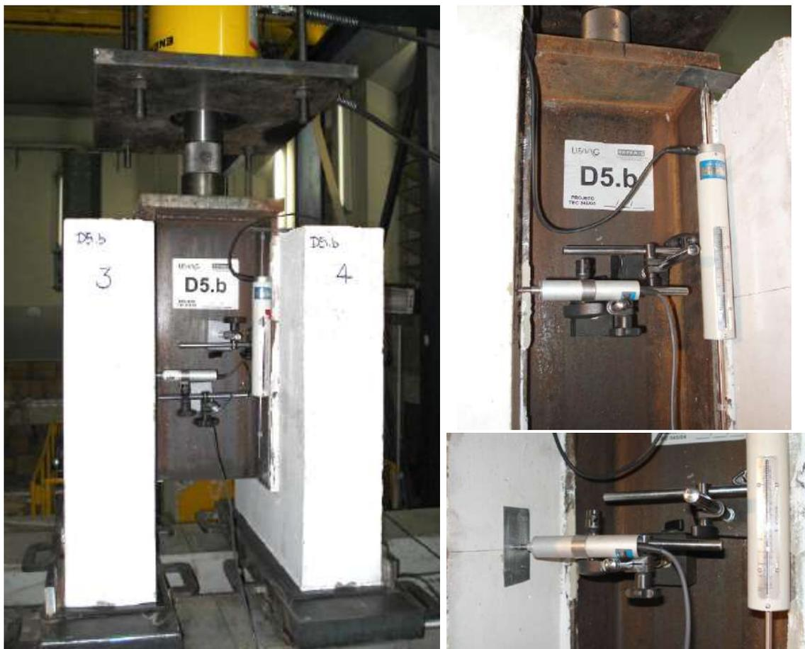
FIGURA 3.99 – Posicionamento dos transdutores de deslocamento.
