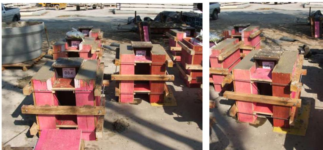
FIGURA 3.91 – Modelos concretados – série D.
