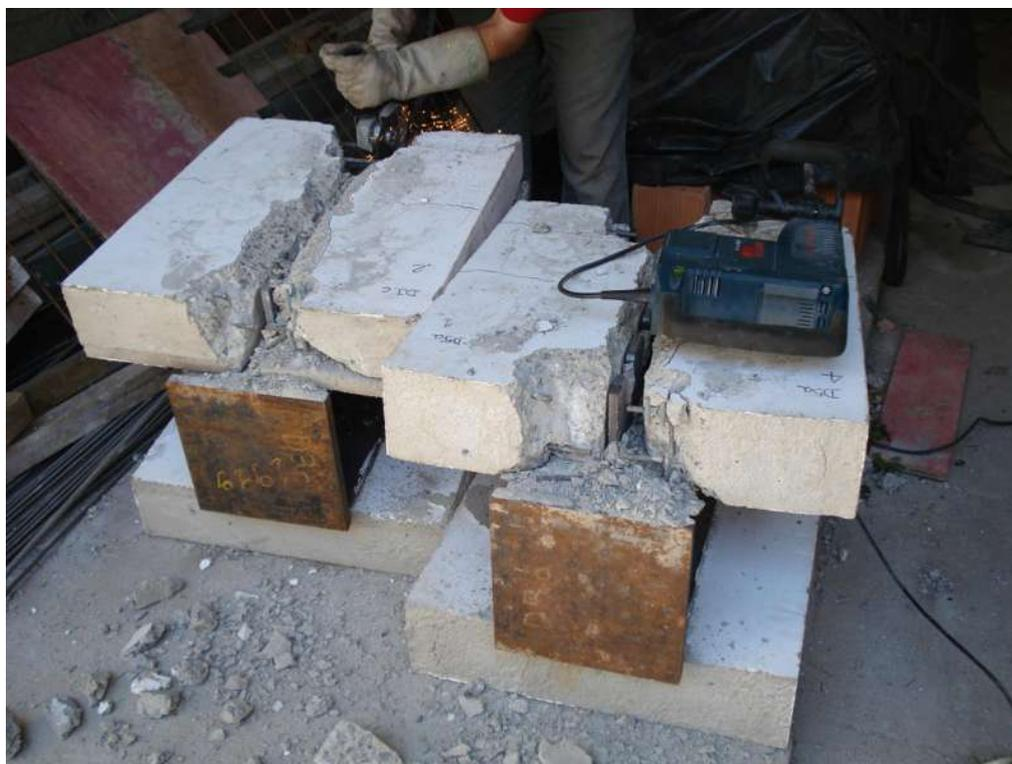
FIGURA 3.109 – Corte das lajes - série D.
