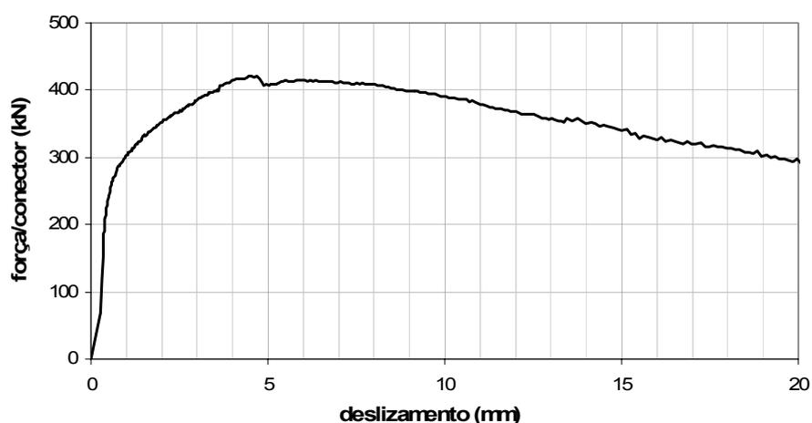
FIGURA 2.1 - Curva força-deslizamento.
