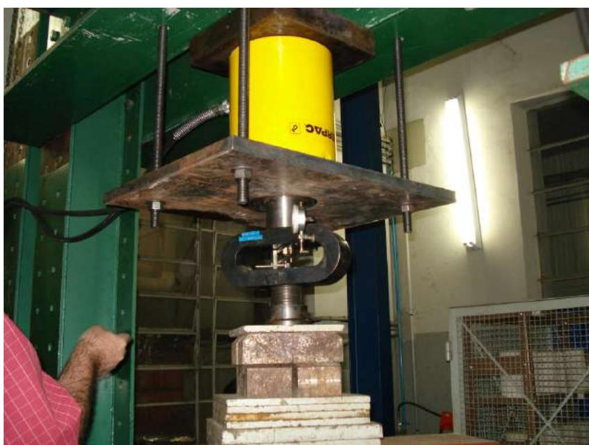
FIGURA 3.98 – Calibração do atuador hidráulico.
