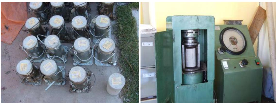
FIGURA 3.93 – Controle tecnológico do concreto – série D.
