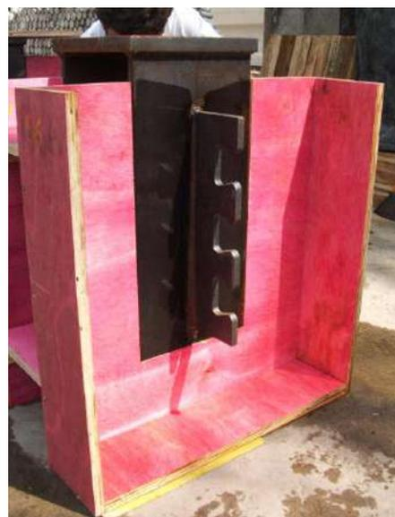
FIGURA 3.84 – Aplicação de desmoldante nas fôrmas - série D.
