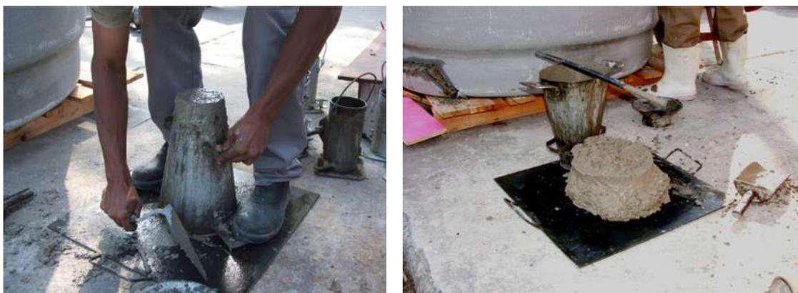
FIGURA 3.89 – Ensaio de SLUMP – série D.
