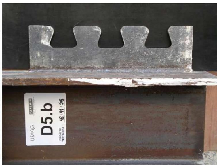
FIGURA 3.112 – Conector intacto após ensaios da série D.
