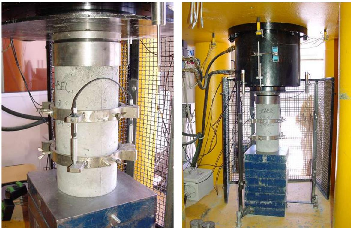
FIGURA 3.42 – Ensaio para determinação do módulo de elasticidade.
