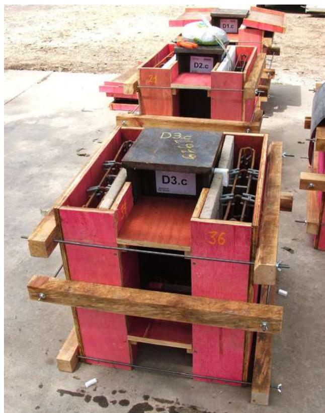
FIGURA 3.88 – Fase final da montagem dos modelos – série D.
