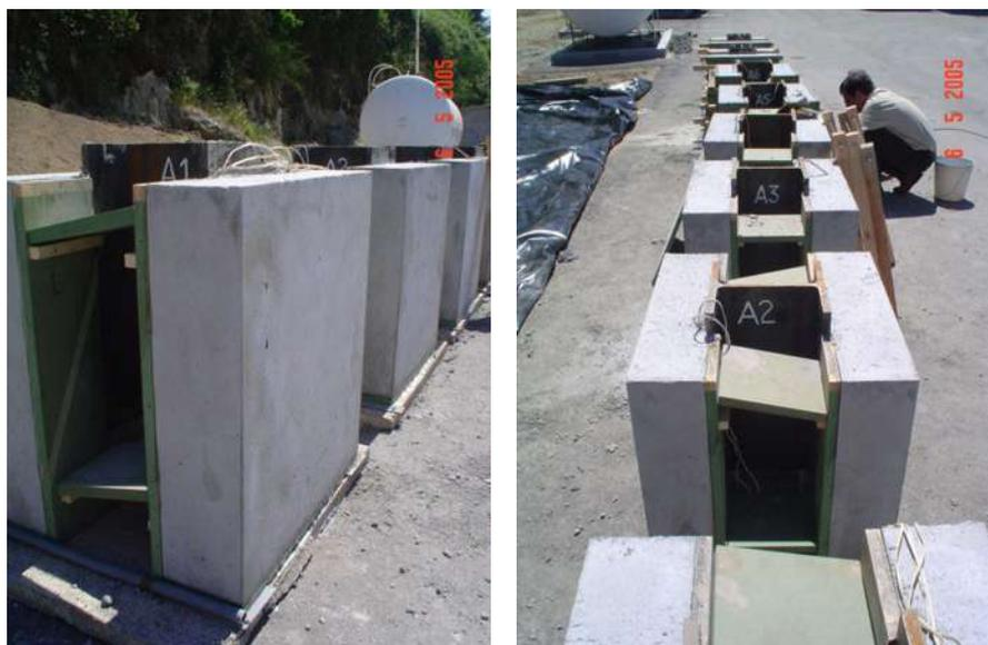
FIGURA 3.22 – Modelos da série A na fase de desmoldagem.
