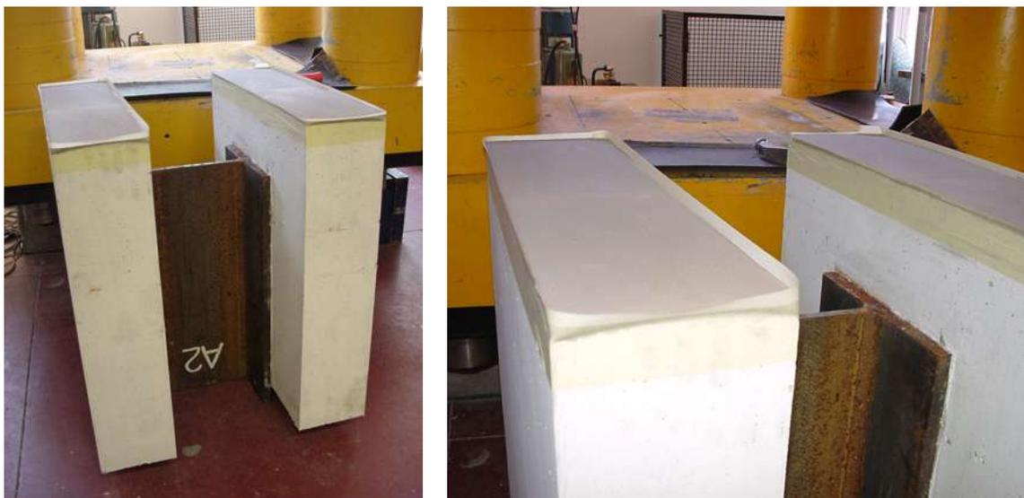
FIGURA 3.24 – Regularização das lajes com argamassa auto-nivelante.
