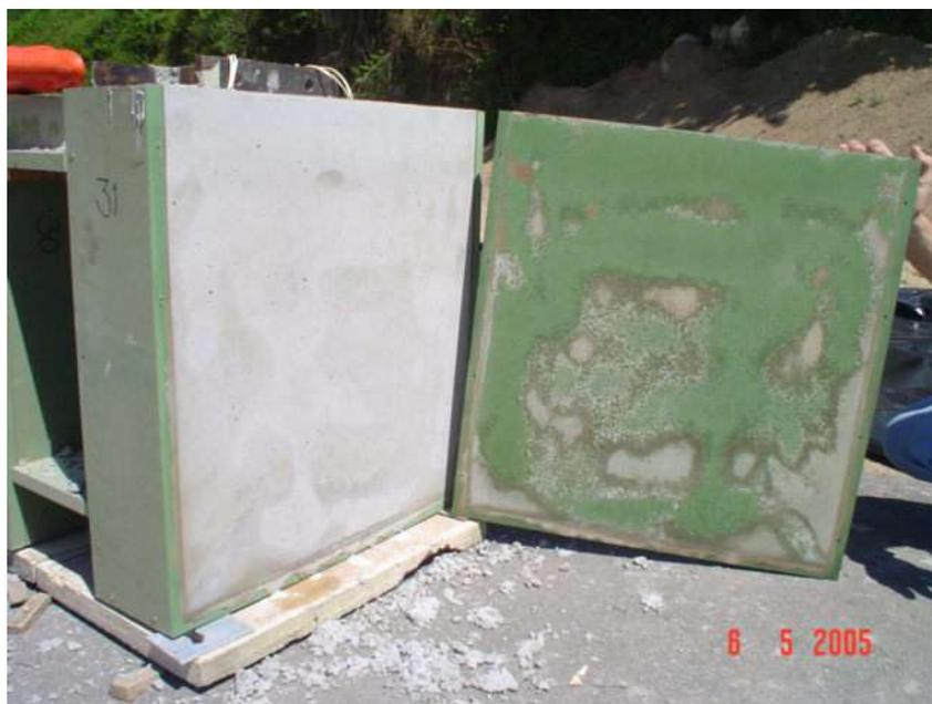
FIGURA 3.23 – Aspecto do concreto e da fôrma após desmoldagem (fôrma de MDF hidrófugo com verniz selador e desmoldante da SIKA).
