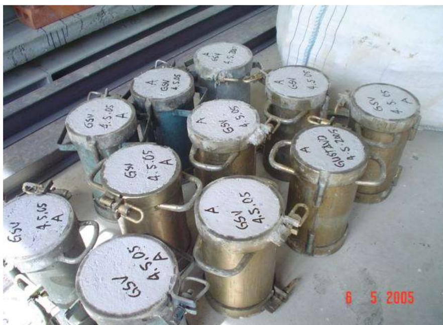
FIGURA 3.38 – Corpos-de-prova cilíndricos para caracterização do concreto.
