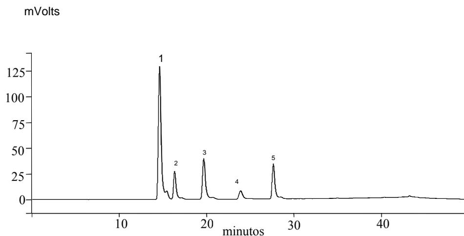
**FIGURA 3.** Cromatograma da solução de ácidos fenólicos ( $1,0 \times 10^{-5} \text{ mol L}^{-1}$ ) com detecção espectrofotométrica em 330 nm. Identificação dos picos pelo tempo de resposta (tr): 1 = ácido caféico (tr = 14,6 min); 2 = vanilina (tr = 16,7 min); 3 = ácido p-cumárico (tr = 19,9 min); 4 = ácido m-cumárico (tr = 24,7 min); 5 = ácido o-cumárico = 28,3 min.
