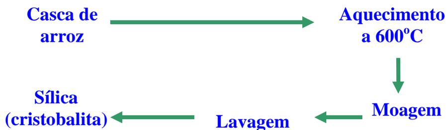
**Figura 6:** Processo de obtenção da sílica
