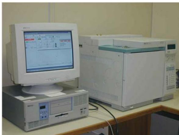
Figura 6. Cromatógrafo gasoso Shimadzu GC14-B com detector de FID.
