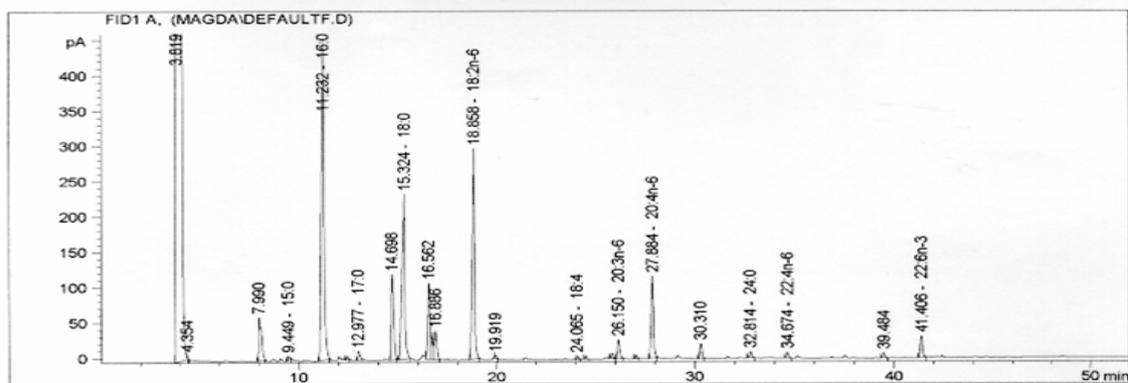
Figura 7. Cromatograma obtido por cromatografia gasosa demonstrando os picos com seus respectivos tempos de retenção e ácidos graxos identificados, onde o primeiro número representa o tempo de retenção (e.g. 15.324) e o segundo o ácido graxo representado por aquele pico (e.g. 18:0, 22:4n-6).
