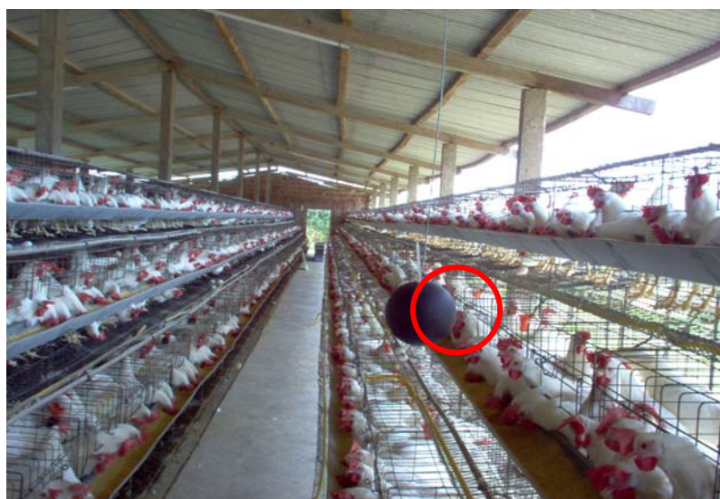
Figura 05 – Detalhe do globo negro no centro de massa das aves
