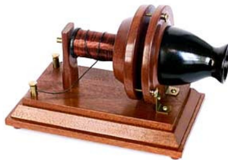
Figura 6: réplica de um dos primeiros telefones “reversível de mesa” (Ano: 1875) 18 .
