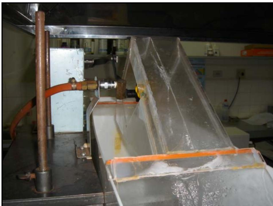
**Figura 2.** Sistema responsável pela movimentação da ponta de pulverização transversalmente ao feixe de luz.
