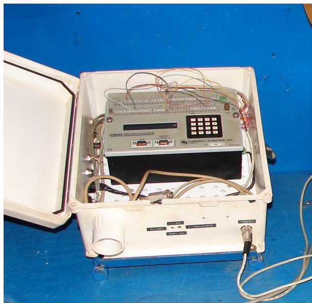
Figura 9 - Coleta de dados, composto pelo Micrologger CR23X
