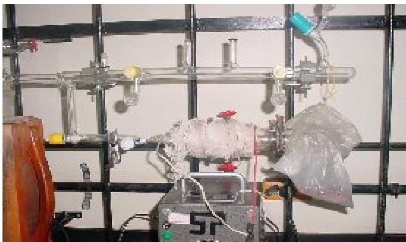
Figura 9. Aparato experimental usado na termoanálise no infravermelho.
