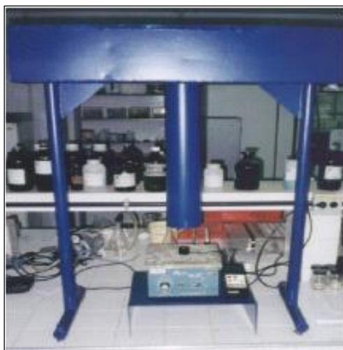
Figura 3.11: Colimador UV para testes cinéticos em batelada.
