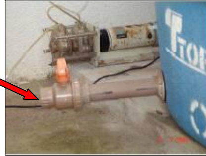
Figura 4.14 . Coleta da amostra do fundo do reservatório
