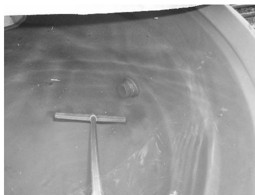
Figura 35 – Revolvimento do material sedimentado no fundo do reservatório para posterior coleta da amostra
