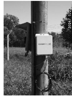
Figura 38 – DataLogger da Estação Meteorológica do Parque Experimental do Núcleo Água
