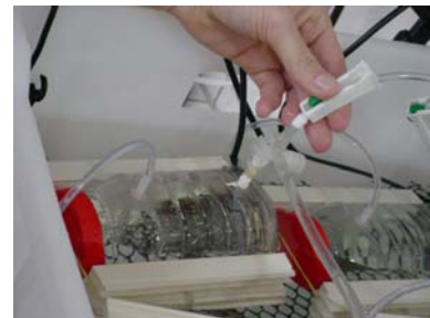
Anexo 8: Passos para fechar sistema de respirometria: A: conexão da saída do respirômetro com entrada do sistema de bomba; B: abertura da conexão de entrada do respirômetro; C: conexão da saída do sistema de bomba com conexão de entrada do respirômetro; D: Fechamento da entrada de água de recirculação do respirômetro.
