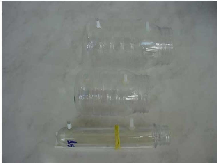
Anexo 1: Recipientes utilizados como respirômetros.
