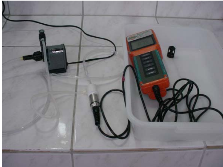
Anexo 4: Sistema para leitura dos valores de oxigênio dissolvido (bomba + oxímetro)
