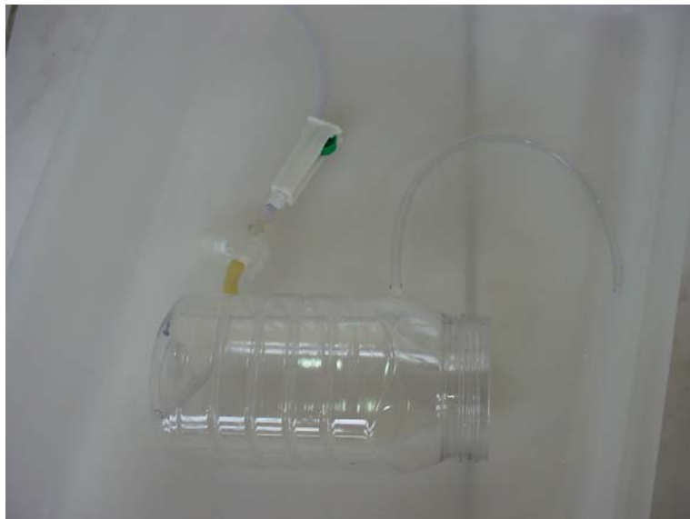
Anexo 2: Respirômetro com as conexões de entrada e saída de água
