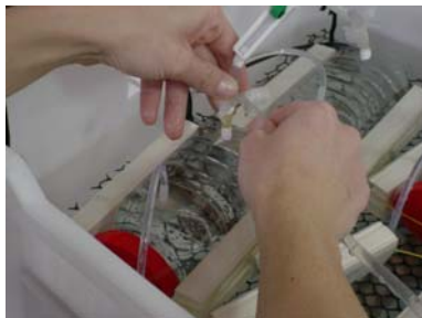
Anexo 8: Passos para fechar sistema de respirometria: A: conexão da saída do respirômetro com entrada do sistema de bomba; B: abertura da conexão de entrada do respirômetro; C: conexão da saída do sistema de bomba com conexão de entrada do respirômetro; D: Fechamento da entrada de água de recirculação do respirômetro.
