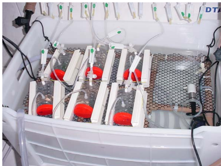
Anexo 6: Caixa com respirômetros semi-submersos conectados ao sistema de recirculação de água.
