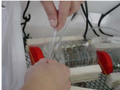
Anexo 7: Oxímetro conectado ao sistema para leituras.
