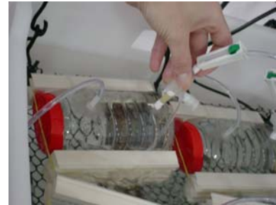
Anexo 7: Oxímetro conectado ao sistema para leituras.
