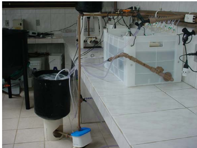
Anexo 5: Sistema de respirometria.
