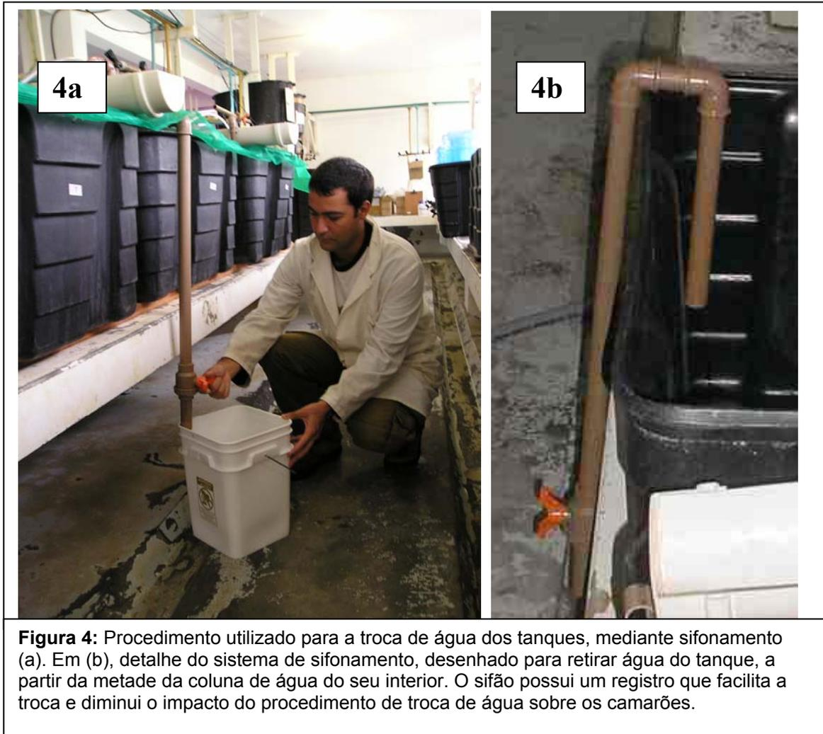
**Figura 4:** Procedimento utilizado para a troca de água dos tanques, mediante sifonamento (a). Em (b), detalhe do sistema de sifonamento, desenhado para retirar água do tanque, a partir da metade da coluna de água do seu interior. O sifão possui um registro que facilita a troca e diminui o impacto do procedimento de troca de água sobre os camarões.
