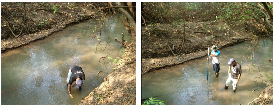
Figura 14. Ponto 5 de amostragem em 24/05/2007, coleta da água e medição de vazão .
