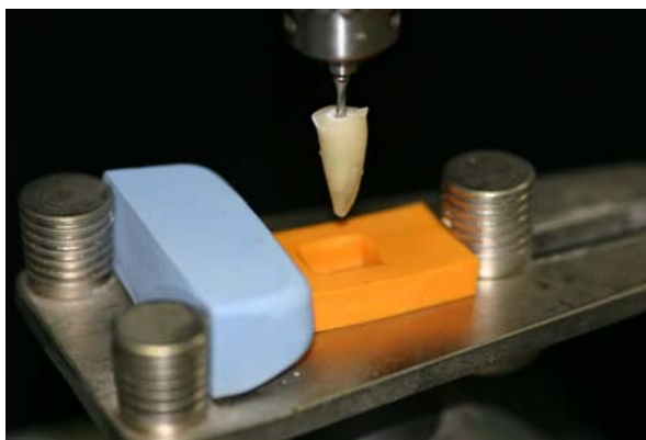
FIGURA 3 - Espécime preso ao mandril do delineador com uma broca, para embutimento em resina acrílica.
