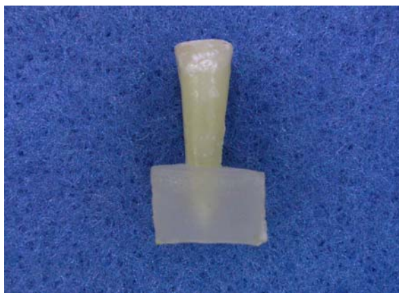
FIGURA 4 - Espécime após embutimento em resina acrílica.
