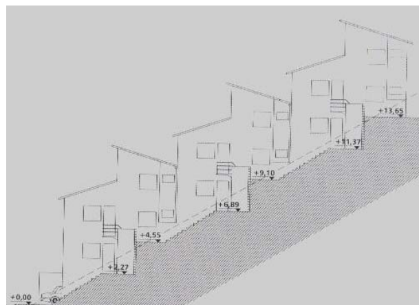
ILUSTRAÇÃO 50: Tipologia habitacional adequada a encostas com declividades superiores a 30%. Fonte: FARAH, 2003.
