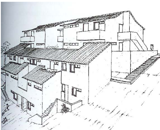
ILUSTRAÇÃO 49: Tipologia habitacional adequada a encostas com declividades superiores a 30%. Fonte: ANDRADE; SOUZA, 1986.
