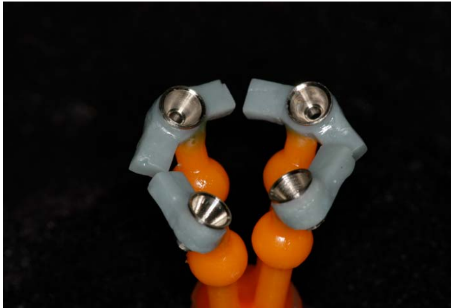
FIGURA 13 – Os quatro segmentos de cada estrutura foram unidos em conjunto aos canais de alimentação.
