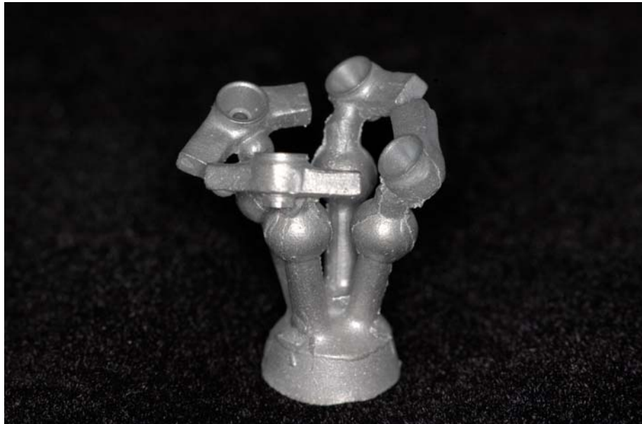
FIGURA 15 – Fundição removida do revestimento.
