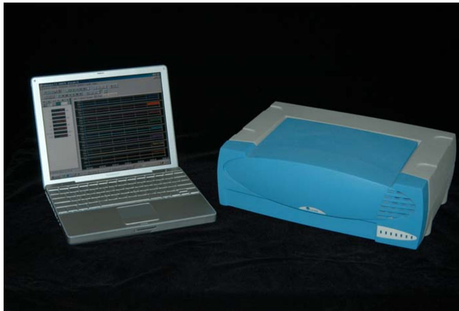
FIGURA 23 – Sistema de condicionamento e conversão do sinal, e software para aquisição, análise e processamento de dados.
