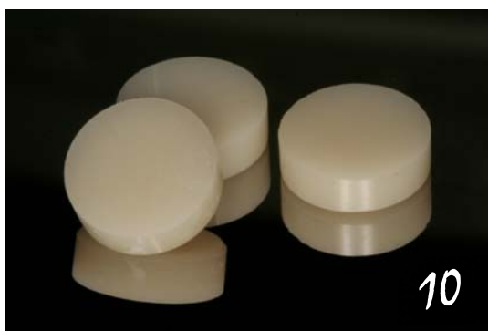
Figura 10. Discos de cerâmica EE e E2 (3 mm espessura x 10 mm diâmetro) após o corte.
