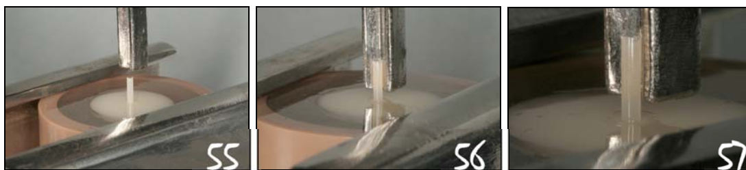
Figuras 55 a 57. Ao ser abaixado, o dispositivo superior permite que o espécime seja encaixado no sulco.
