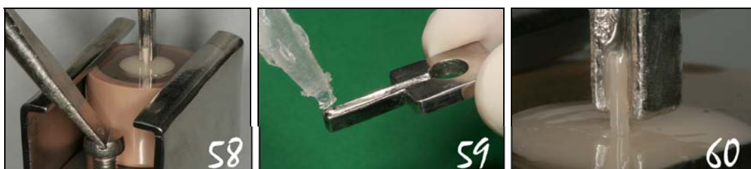
Figuras 58 a 60. Fixação do corpo de prova ao dispositivo inferior pelo aparafusamento (58) e fixação do espécime de resina ao dispositivo superior móvel (59 e 60).
