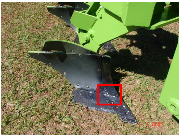
Figura 19 - Detalhe da ponteira com revestimento de eletrodo. Fonte: IKEDA
