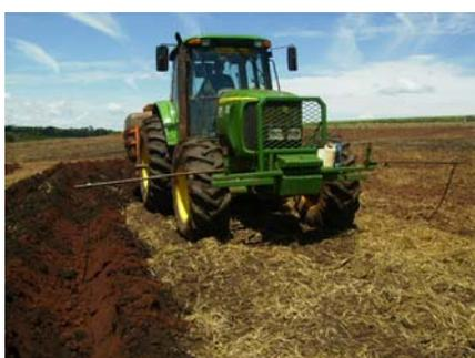
Figura 13 - Trator de sulcação com o dispositivo de orientação
