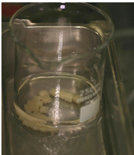
FIGURA 4- Blocos cerâmicos no aparelho sônico.
