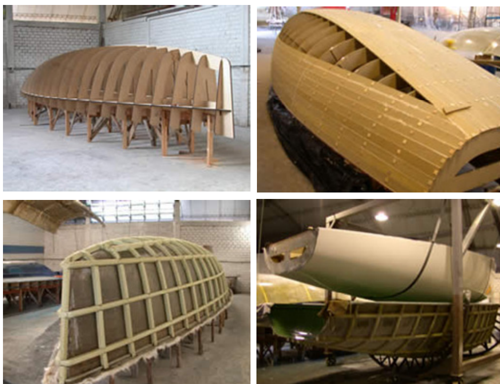
Figura 8. Etapas de processo construtivo (veleiro Skipper 30)
