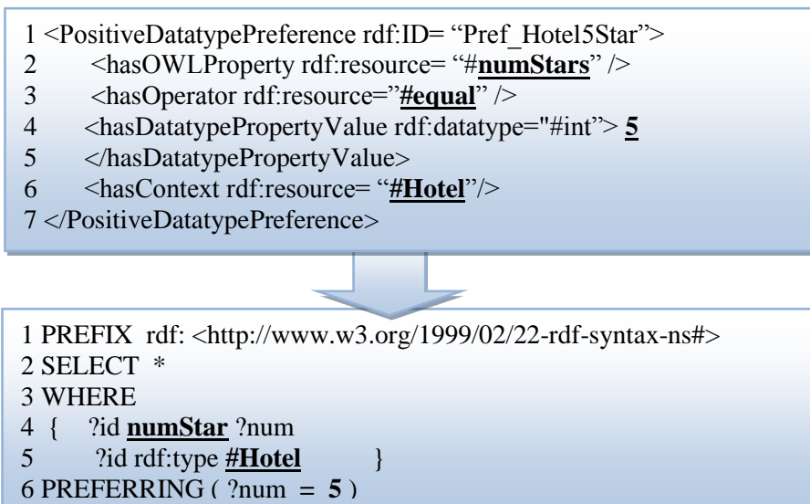
Figura 33. Exemplo de mapeamento de uma preferência em OWLPREF para uma sentença SPARQL Preference
