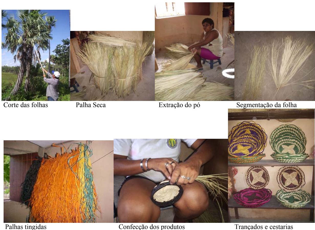
Figura 4 – Processo produtivo dos trançados e cestarias da palha da carnaúba
