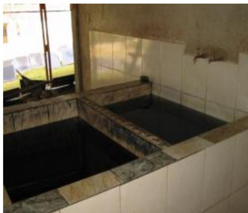
**Figura 2.19** - Tanque de massa / polpa.
