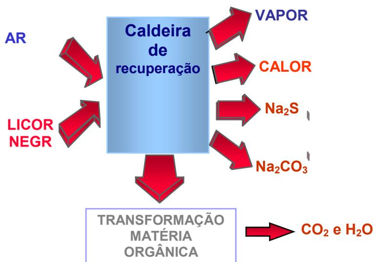
**Figura 2.12** - Fluxo esquematizado da caldeira de recuperação.
