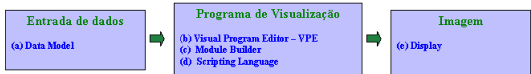
Figura 2.1: Esquema sintético de funcionamento do OpenDX
