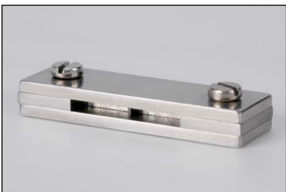
Figura 12 - Matriz tripartida utilizada na confecção dos espécimes para teste de tenacidade à fratura.
