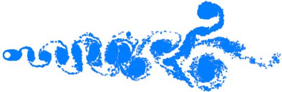
Figura 12 – Posição dos vórtices na esteira no instante t= 40 . ( \lambda= 0 , A= 0 , Euler, Mb = 50 , Mg = 50 \Delta t = 0,05 , \sigma_0 = \text{eps} = 0,009 , Re = 10^5 ).
