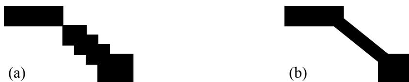
Figura 2.14 - (a) ocorrência do efeito dobradiça; (b) pescoço obtido por otimização de forma.
