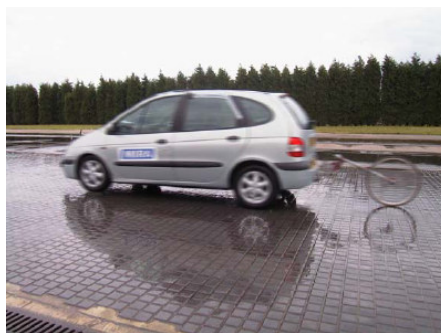
Figura 1.1. – Aferição de velocímetro utilizando roda padrão [URL 5]
