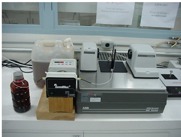
Figura 3.3 Espectrômetro FT-NIR BOMEM utilizado para as análises de óleo diesel.
