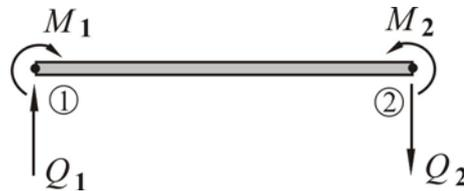
Figura 6.4 – Convenção de sinais usada na teoria elementar de viga.
