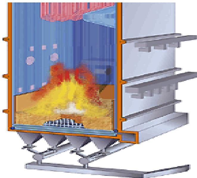
Figura 4.4: Câmara de Combustão da Caldeira de Leito Fluidizado Borbulhante.
