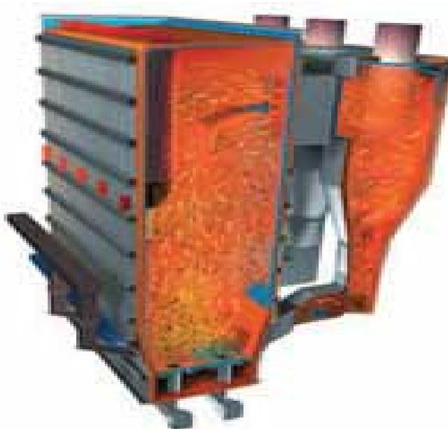
Figura 4.5: Câmara de Combustão da Caldeira de Leito Fluidizado Circulante.
