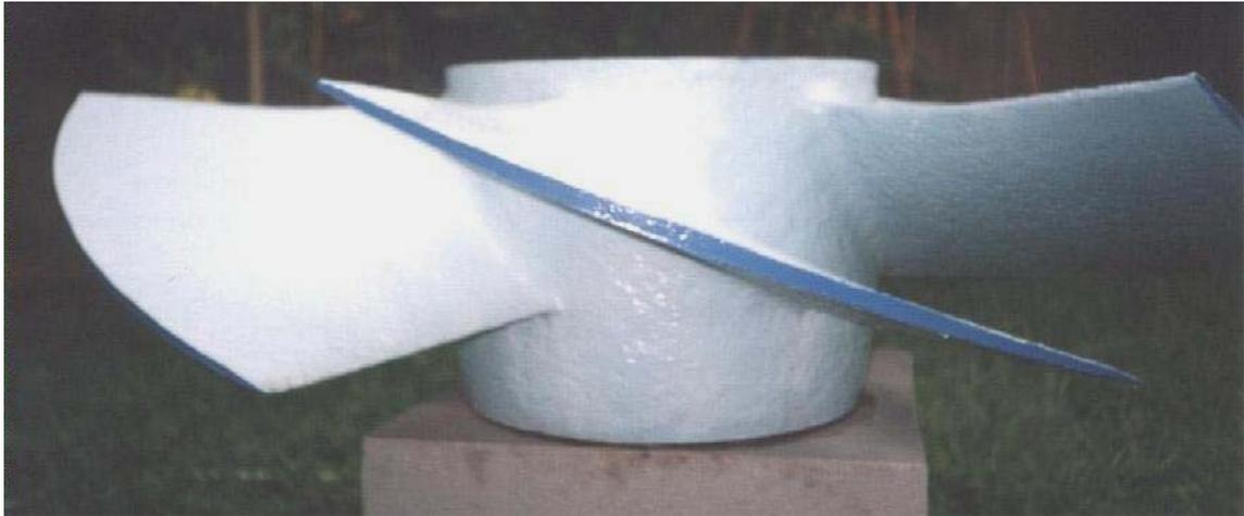
Figura 4 – Exemplo de rotor hélice (LHPCH – UNIFEI). Notar a esbeltez dos perfis.
