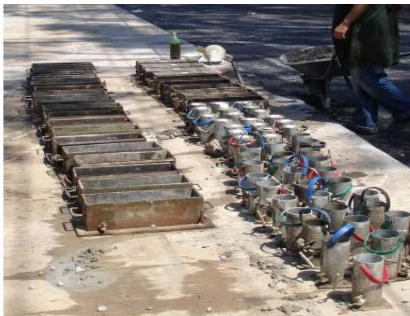
Figura 13 Moldagem de corpos de prova.
