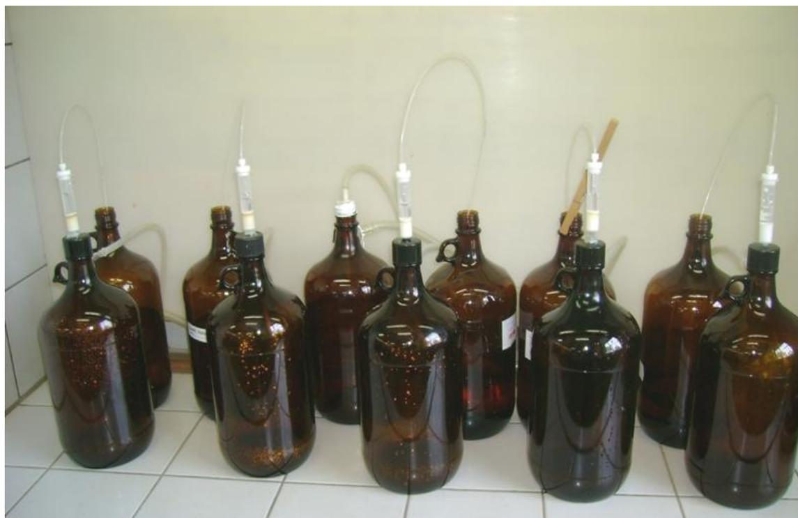
**Figura 21:** EFS : 2 amostras da ETA Sumaré, 2 amostras ETA Campinas e 1 amostra fortificada.
