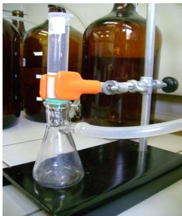
**Figura 22:** Sistema de eluição dos analitos percolados no cartucho.
