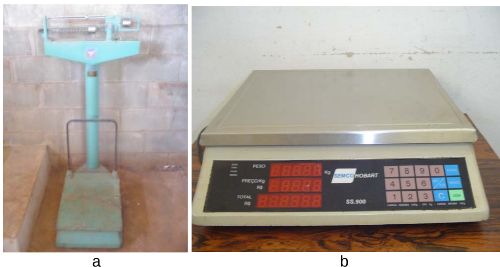
Figura 4.5 Balança mecânica (a) e eletrônica (b) utilizadas na pesagem de resíduo
