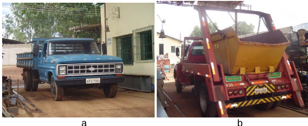
Figura 4.10 Caminhão F-4000 (a) e caminhão F-12000 (b) da DMA/UNICAMP, sendo pesados, em ferro velho no distrito de Barão Geraldo, para retirada de suas taras
