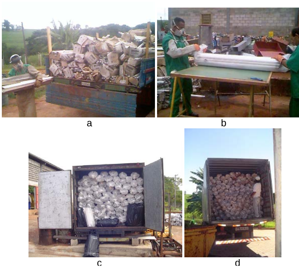
Figura 4.14 Coleta (a), acondicionamento (b), armazenagem (c) e carregamento para transporte (d) das lâmpadas fluorescentes geradas pela UNICAMP
