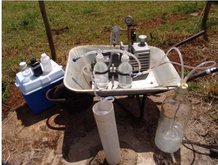
Figura 4.6-1 – Conjunto utilizado para amostragens nos poços de monitoramento.
