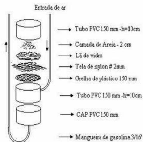
Figura 4.6-3 – Coletores de amostras de água drenagem livre
