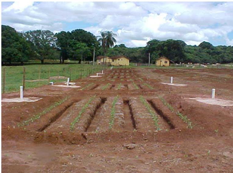
Figura 4.4-2– Vista da área do experimento com poços de monitoramento instalados na Fazenda Marfim – Rifaina-SP
