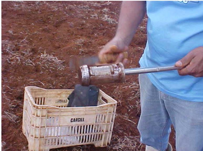
Figura 4.5-10– Detalhe da coleta de solo utilizando o trado Uhland
