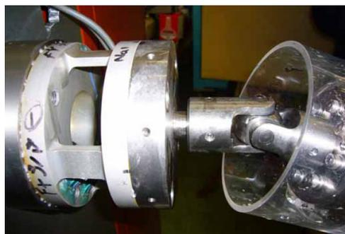
b- Detalhe da célula de carga para medição das forças hidrodinâmicas.
