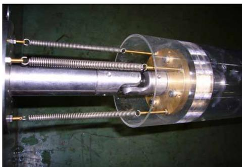
a- Detalhe das molas para aplicação da força axial.
