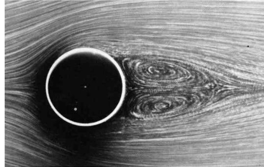
Fig. 3.4 - Escoamento ao redor de um *riser* para  $Re= 26$ . Pode-se verificar o alongamento da esteira [22].
