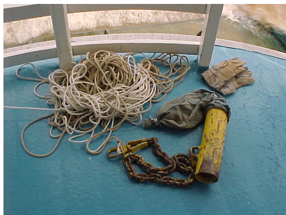
Figura 18 – Amostrador de sedimentos do leito do tipo de raspagem horizontal.
