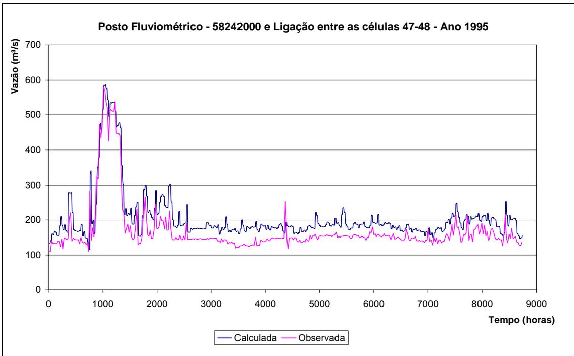
Figura 40. Calibração do rio Paraíba do Sul, ligação entre células 47-48.
