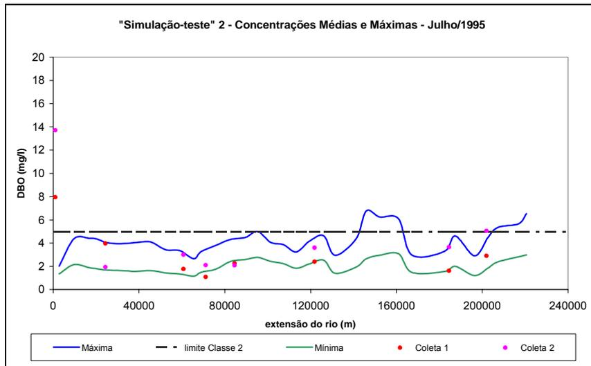
Figura 56. Concentrações de DBO mínimas e máximas da “Simulação-teste” 2 para o mês de julho de 1995.
