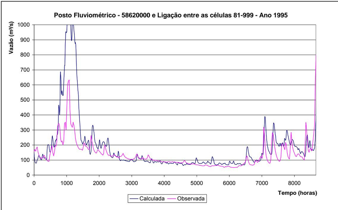
Figura 46. Calibração do rio Paraíba do Sul, ligação entre as células 81-999.
