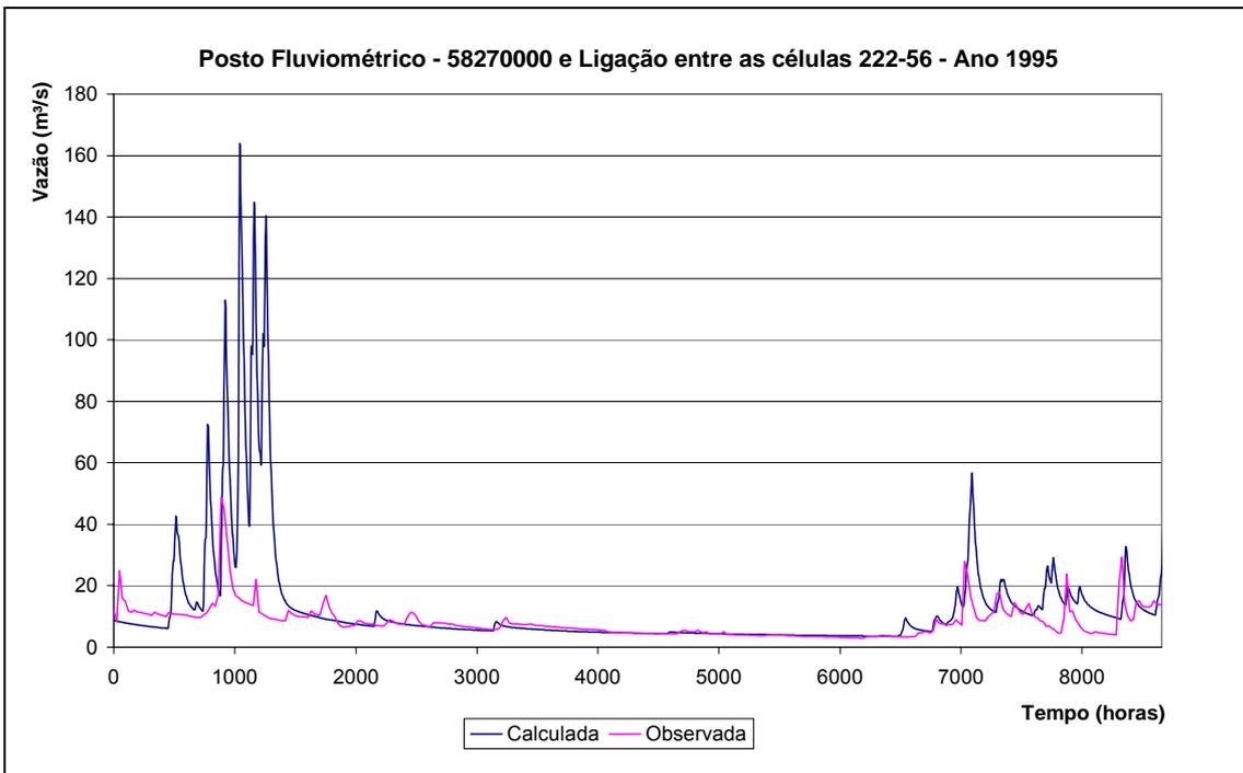
Figura 47. Calibração do rio Paraíba do Sul, ligação entre as células 222-56.
