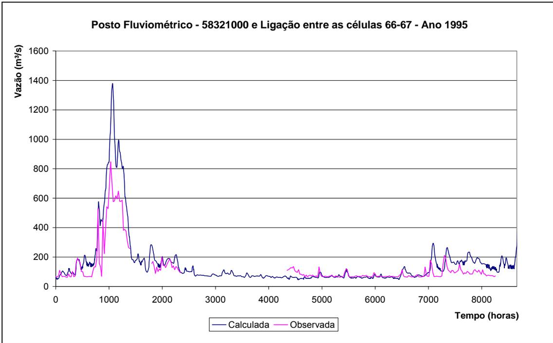
**Figura 44. Calibração do rio Paraíba do Sul, ligação entre as células 66-67.**
