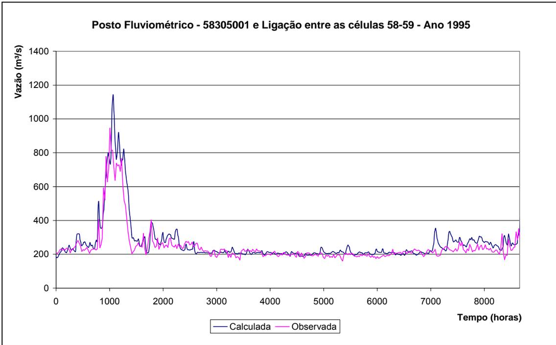
**Figura 42. Calibração do rio Paraíba do Sul, ligação entre as células 58-59.**
