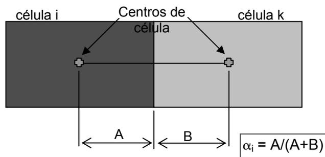
**Figura 23. Esquema ilustrativo para o cálculo do coeficiente de distâncias,  $\alpha_i$ .**
