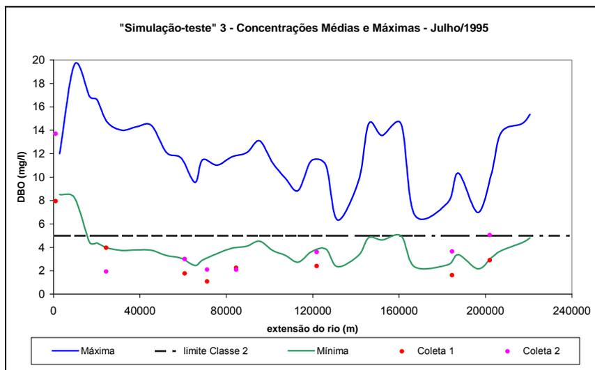
Figura 57. Concentrações de DBO mínimas e máximas da “Simulação-teste” 3 para o mês de julho de 1995.
