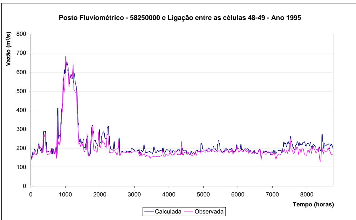
Figura 41. Calibração do rio Paraíba do Sul, ligação entre células 48-49.
