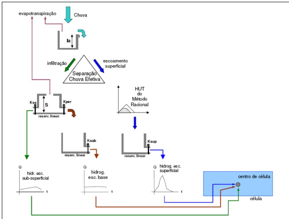
Figura 15. Esquema Geral do Módulo Hidrológico (Fonte: DE MAGALHÃES [2]).
