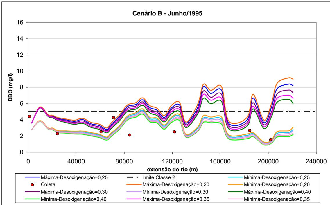
**Figura 77. Calibração do coeficiente de desoxigenação, Cenário B, para o mês de junho de 1995.**
