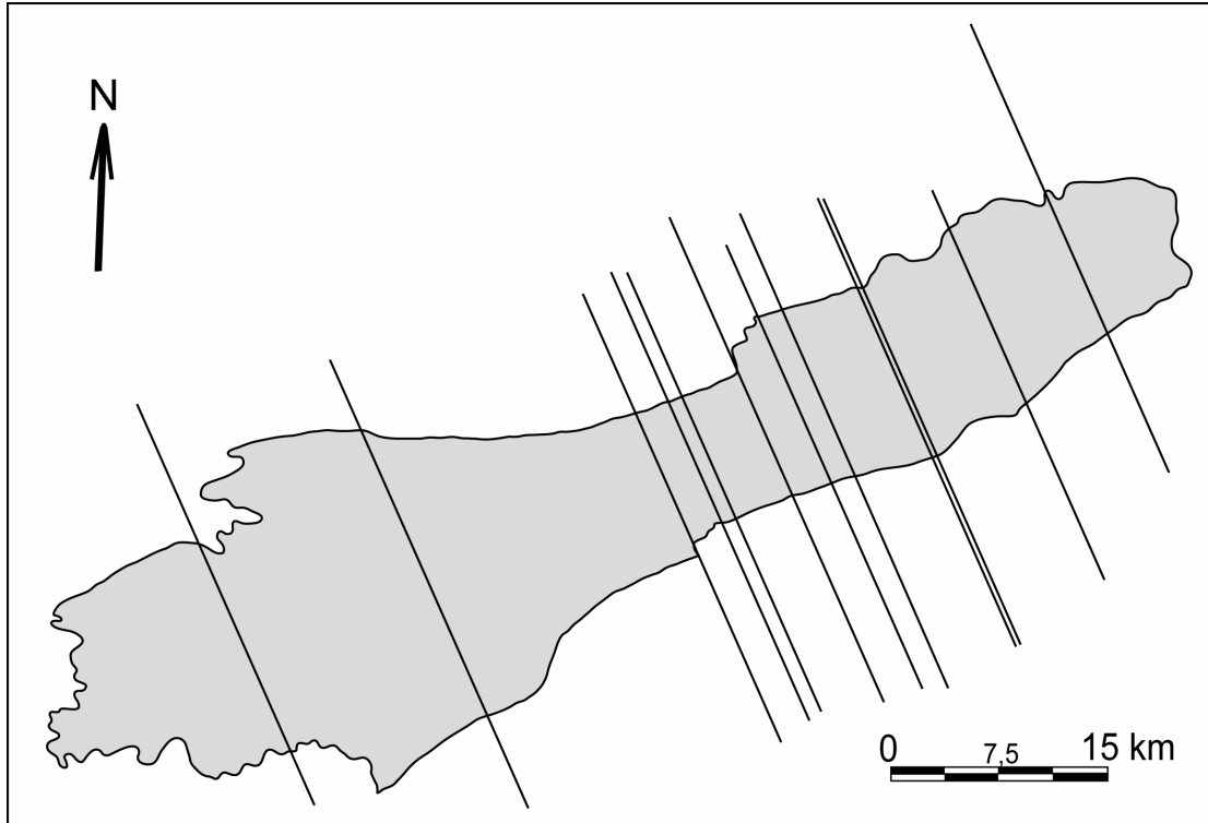
Figura 42- Lineamentos observados nas imagens de satélite, interpretados como sendo falhas geradas durante o Segundo Evento de Deformação.
