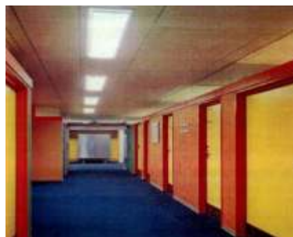
FIGURA 4.11 - Corredor do Hospital Amtssygehus - Iluminação fluorescente com incidência direta sobre os olhos dos pacientes.
