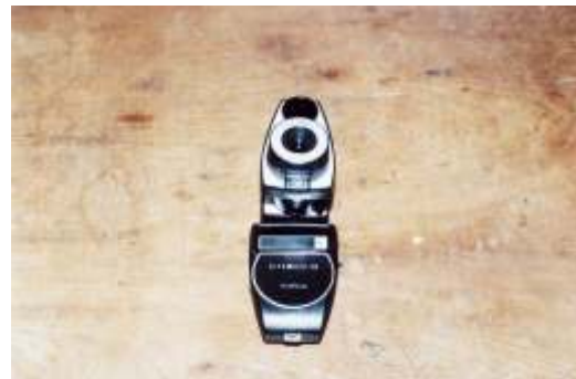
FIGURA 6.15 e 6.16 - Aparelhos utilizados nas medições - luxímetro e luminancímetro
