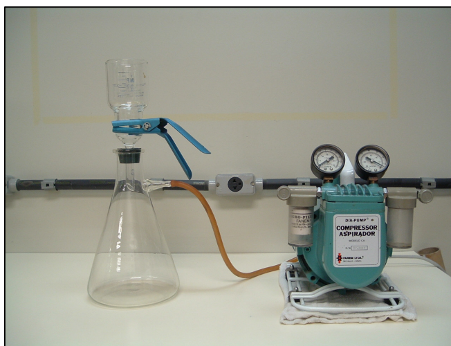
FIGURA 1 - APARELHO DE FILTRAÇÃO USADO PARA RECUPERAÇÃO DE CISTOS DE Giardia duodenalis EM ÁGUA.
