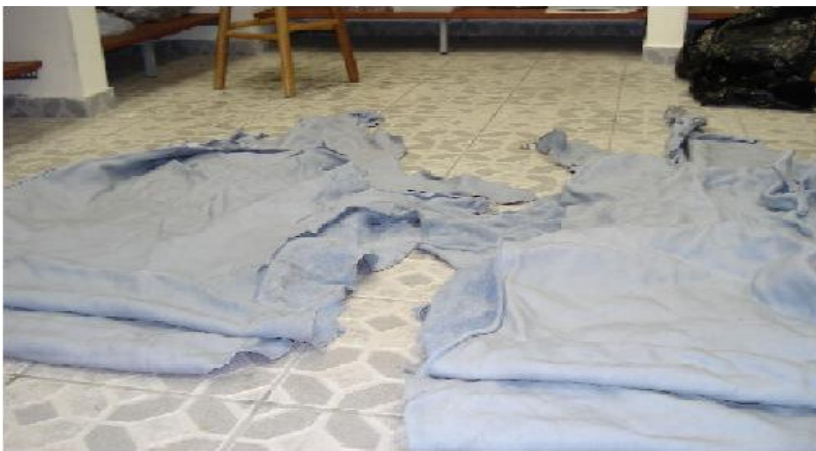
Figura 4.35: Couro wet-blue obtido nos testes em escala industrial
