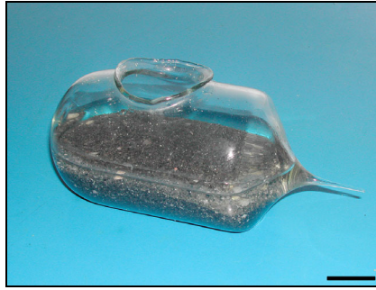
Figura 5 – Recipiente para concentração dos ‘ Candidatus Magnetoglobus multicellularis ’; a barra indica 3 cm.
