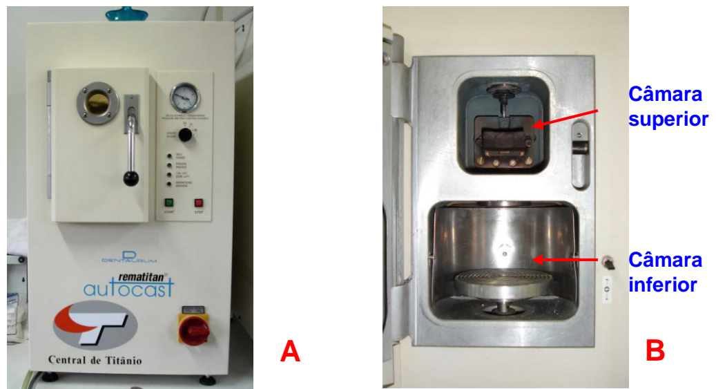
FIGURA 7- Equipamento utilizado para fundição: a) máquina de fundição (Rematitan® Autocast); b) vista interna da máquina de fundição
