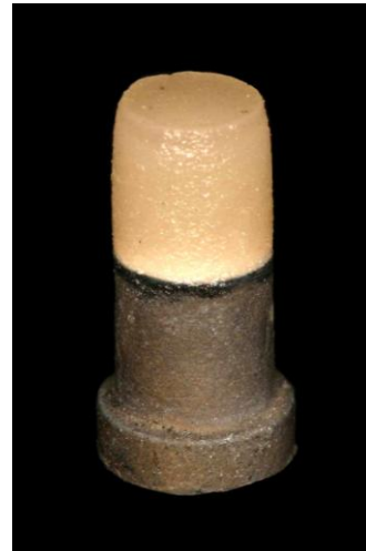
FIGURA 11 – Corpo-de-prova: a) esquema com as respectivas dimensões; b) corpo-de-prova finalizado
