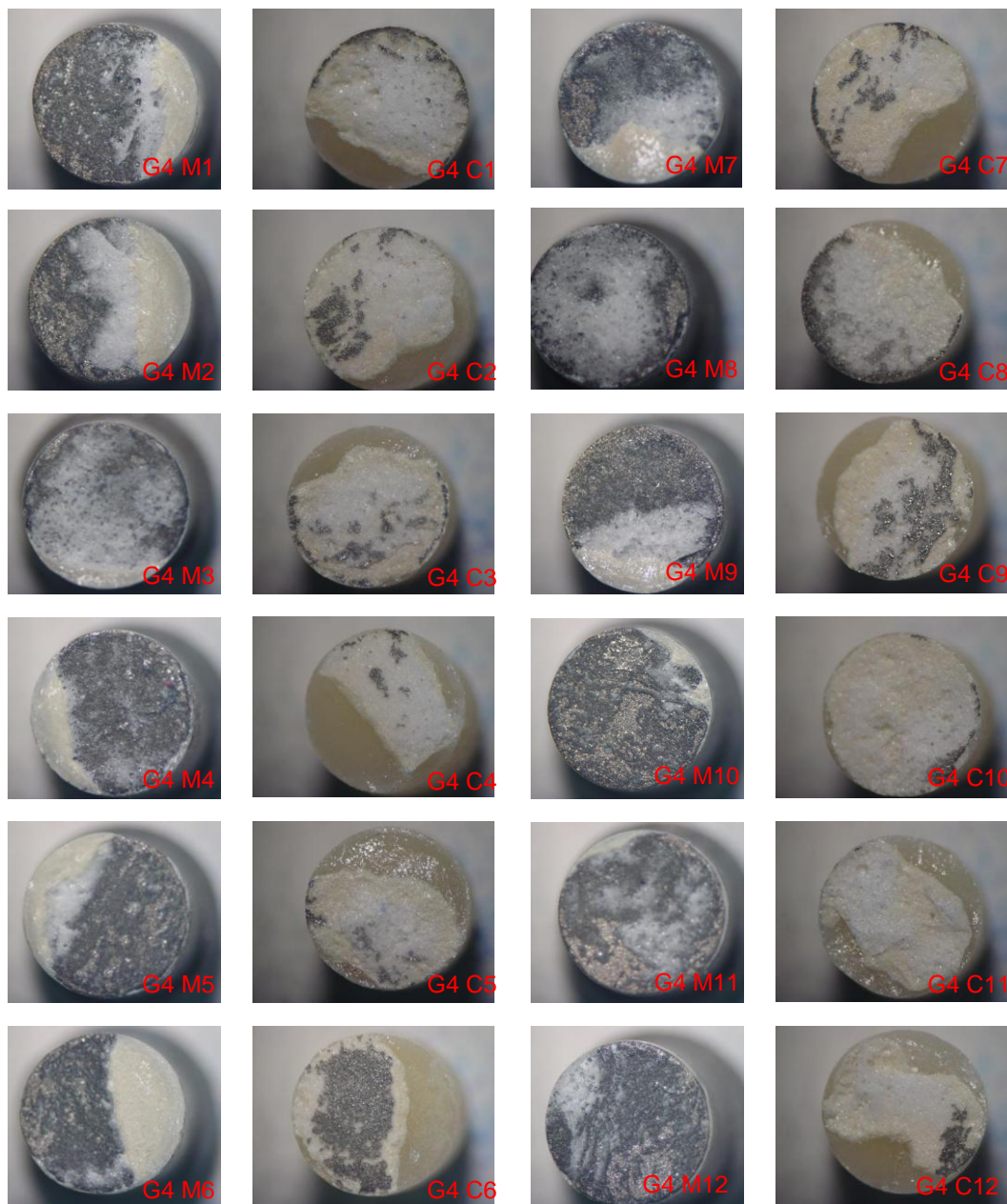
FIGURA 44 - Fotografias dos remanescentes fraturados metálicos (M) e cerâmicos do grupo Titânio cp/Titankeramik (G4) sem ciclagem térmica e mecânica
